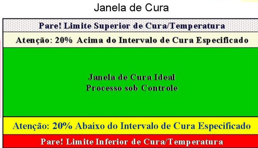
Figura 13: Esquemática da janela de cura. Em verde a faixa ideal de trabalho.
