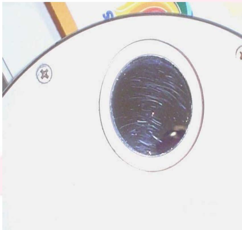
Filtro óptico riscado
