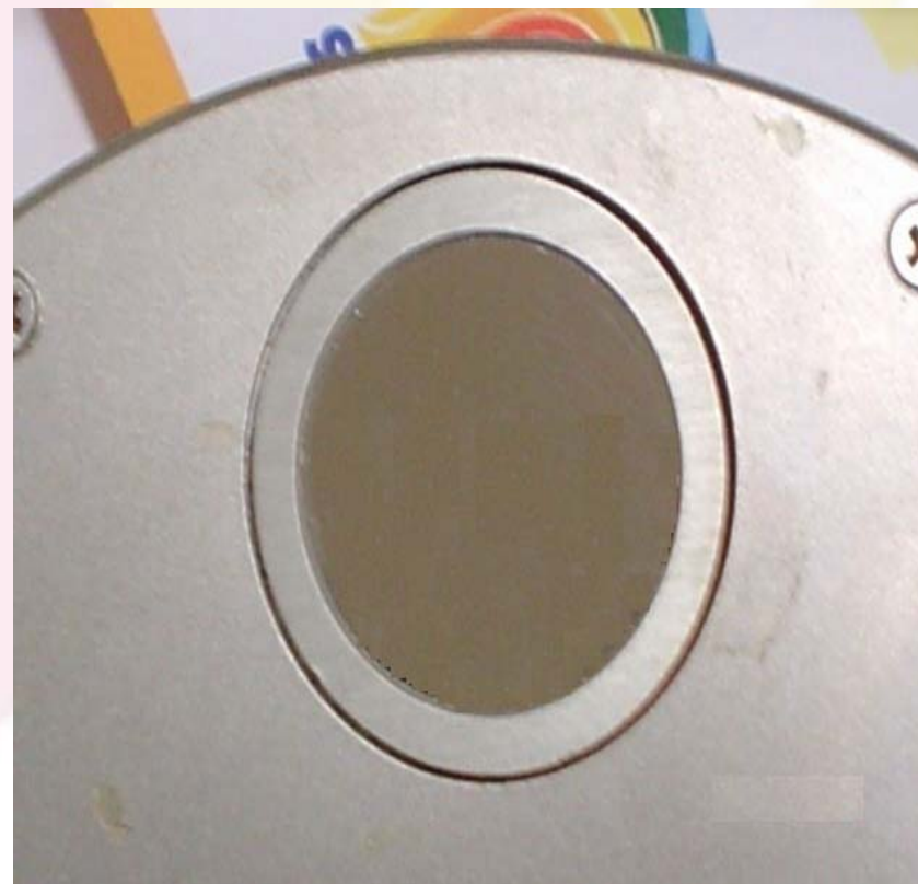
Filtro óptico e radiômetro com respingos de verniz
